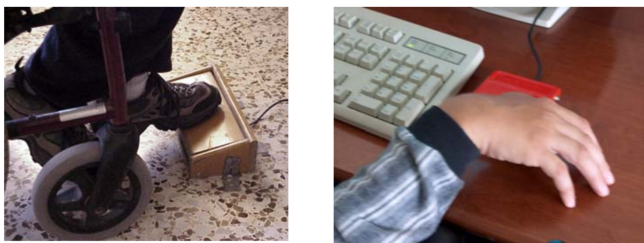
Fig. 2 Modo de acceso por pulsadores de presión
